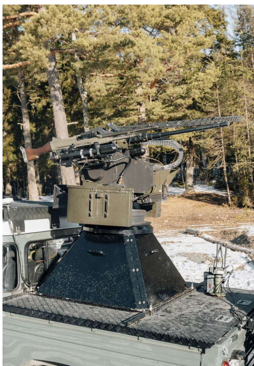
Loke har möjlighet att upptäcka och bekämpa drönare. Vapensystemet sitter vanligtvis på marinens stridsbåtar och består av bland annat en tung kulspruta och en kulspruta 58.
